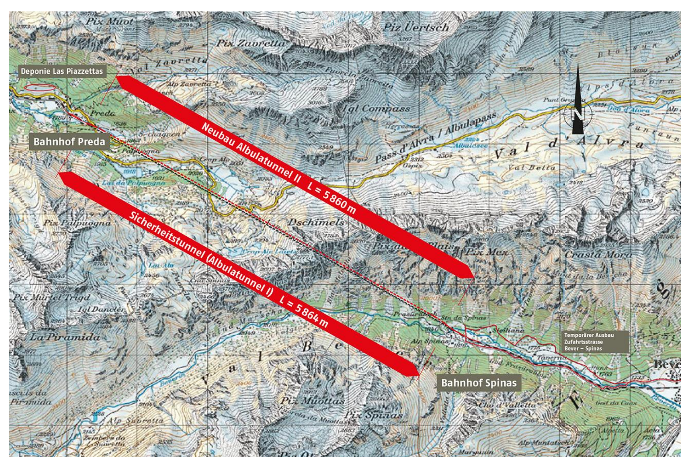
Fig 1: Projektstandort; Quelle: Rhätische Bahn
