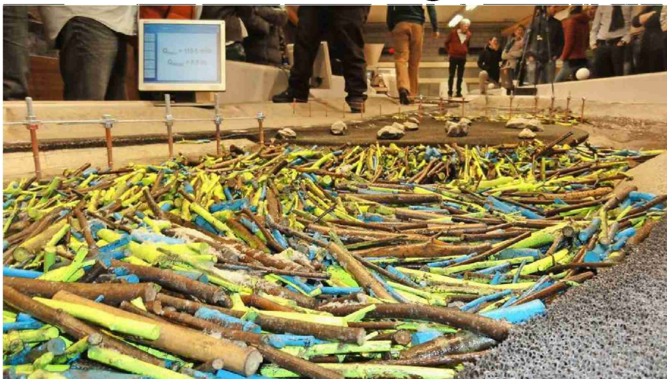
Die vielen bunten Hölzchen symbolisieren angespültes Schwemmhholz im Modellversuch für den Holzrückhalterechen in der Zulg. Die Tests wurden an der Hochschule für Technik in Rapperswil durchgeführt.
