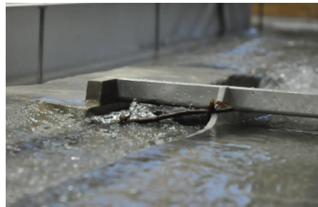
Blick in Fliessrichtung zur oberen Kreiselbrücke. Zusehen ist ein Schwemmholzversuch HQ 100 . Ein Schwemmholz hat sich im Bereich der Geschieberinne zwischen Brücken Widerlager und Mittelabstützung verfangen.
