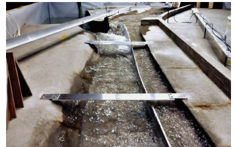
Blick gegen die Fliessrichtung zur Einlauftrumpete der Geschieberinne. Ganz im Vordergrund ist die Fussgängerbrücke, dahinter die bestehende Brücke unterhalb der Kraftwerkszentrale, zu erkennen.
