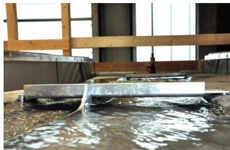
Blick in Fliessrichtung zur oberen Kreiselbrücke. Zu sehen ist ein Geschiebeversuch HQ 100 . Im Hintergrund ist die untere Kreiselbrücke zu erkennen.
