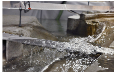
Blick gegen die Fliessrichtung zur bestehenden Brücke unterhalb der Kraftwerkszentrale. Zu sehen ist ein Geschiebeversuch HQ 100 . Aufgrund zu grosser Auflandungen in der Geschieberinne wird die Brücke überströmt. Im Hintergrund rechts ist die Einlauftrumpete der Geschieberinne zu erkennen.
