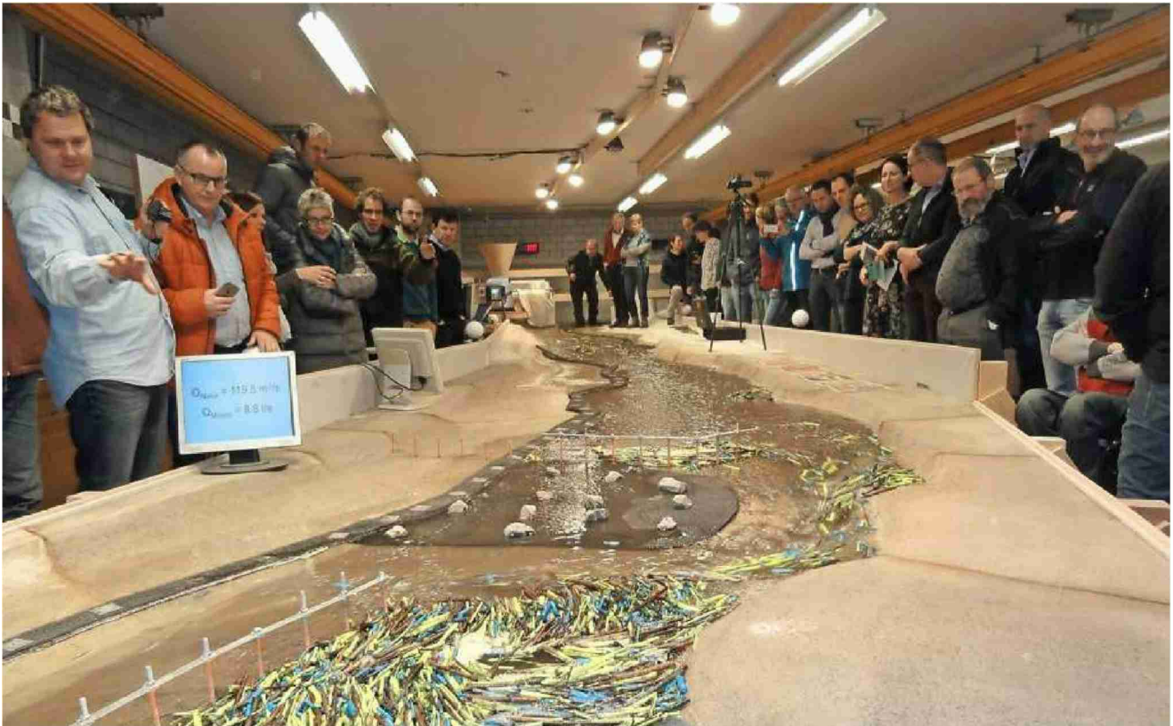
Am Institut für Bau und Umwelt in Rapperswil-Jona liess sich eine Gruppe von Parlamentariern und Behördenmitgliedern aus Steffisburg den Modellversuch mit dem Holzurückhalterechen erklären. Ein Teil der Zulg wurde für die Tests originalgetreu im Massstab 1:45 nachgebaut.
