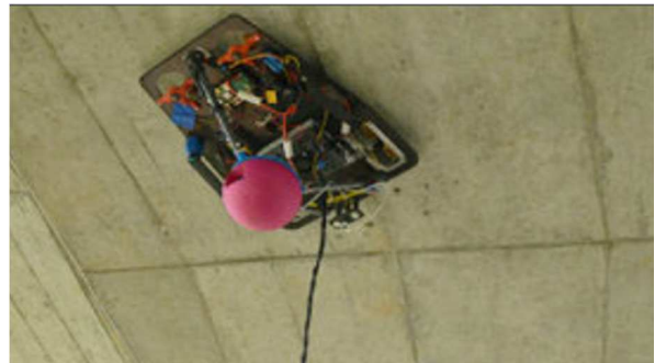
Potentialmessroboter C2D2 an Brückenuntersicht
